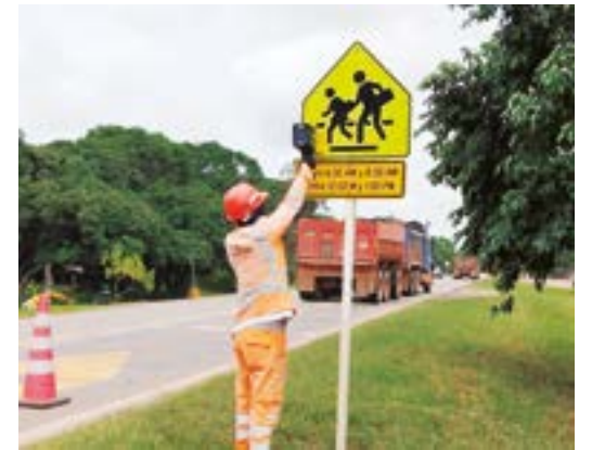
Medición de la luminosidad de las señales verticales.
