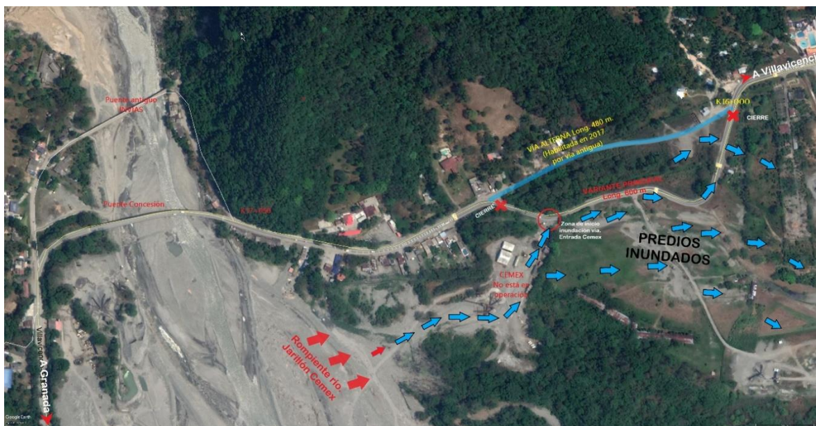
Figura 3. Esquema de la inundación ocasionada por el río Guayuriba en el K16 de la vía a Granada.
